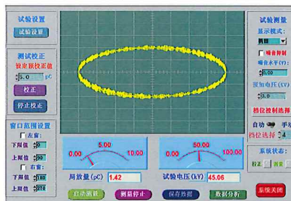
A2: 试验回路1红芯在45kV下局部放电试验图形
