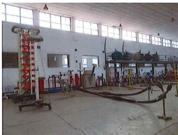
G3: 冲击电压试验 Impulse voltage test
