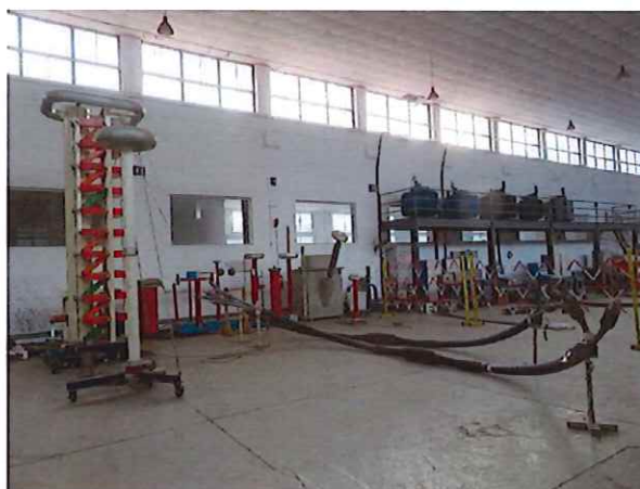
G3: 冲击电压试验 Impulse voltage test
