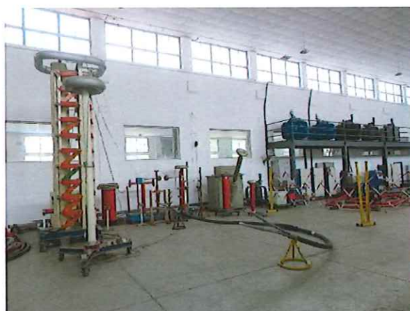
C3: 冲击电压试验 Impulse voltage test
